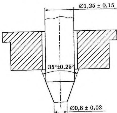
Рис.7 - Индентор твердомера
