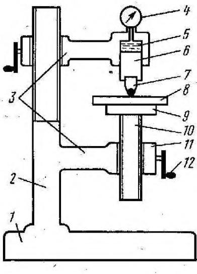
Рисунок 1 – Твердомер Бринелля
