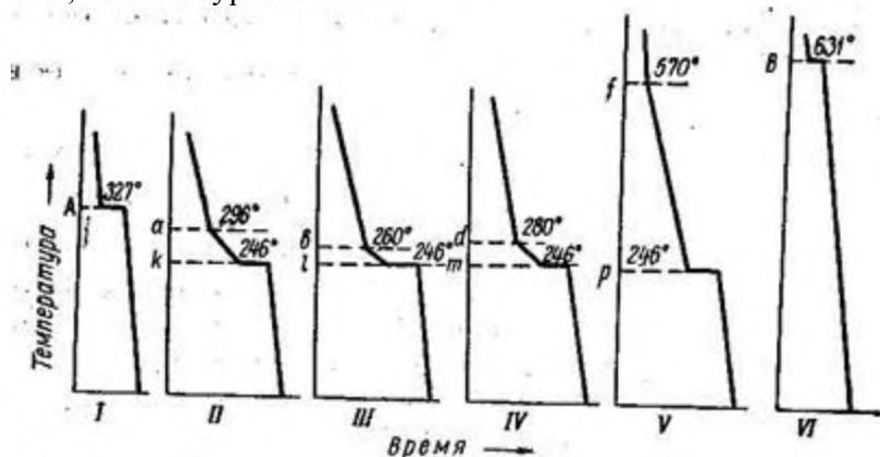
Рис.9 - Кривые охлаждения сплавов системы свинец – сурьма
