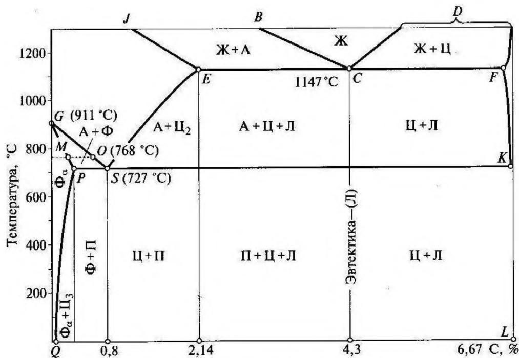
Рис 10 - Диаграмма состояния сплава железо – углерод
