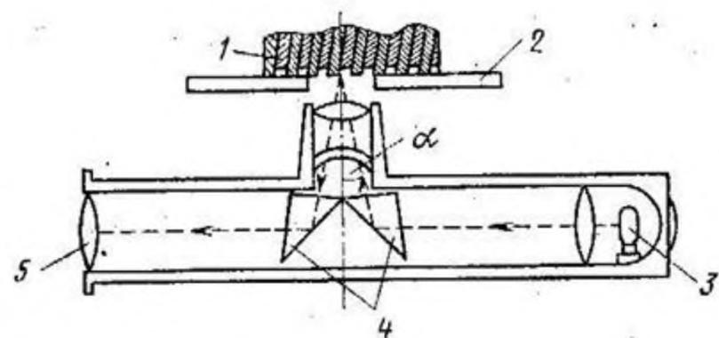
Рис. 5 - Схема металлографического микроскопа:
