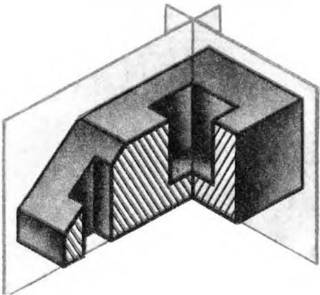
**Второй способ.** Сначала строят аксонометрические проекции фигур сечения, а затем дочерчивают части изображения предмета, расположенные за секущими плоскостями (рисунок 36).
