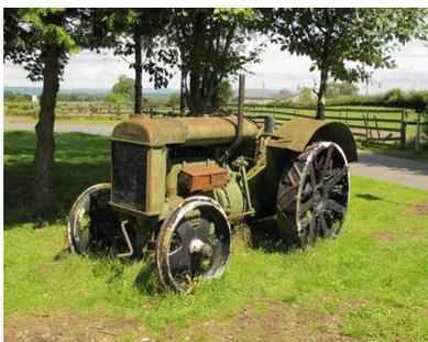
путиловец» сошёл первый трактор, названный «Фодзон-путиловец» с карбюраторным двигателем мощностью 14,7 кВт, работал он на керосине, развивал скорость от 2,3 до 10,8 км/ч. Он выпускался до апреля 1932 года. Именно с этого трактора начинается подлинная история советского тракторостроения.
