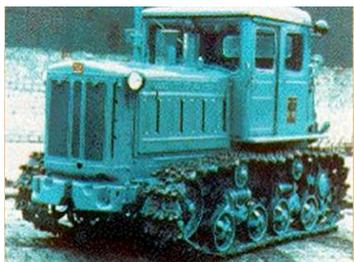
С 1959 года на Харьковском тракторном заводе производится трактор ДТ-75 : двигатель повышенной мощности, рама упрочнена, увеличено число передач переднего хода, пусковой двигатель с электростартером, закрытая двухместная кабина с обогревом и вентиляцией.
